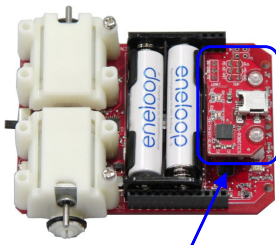
写真 4 : USB シリアル変換基板を搭載した様子
