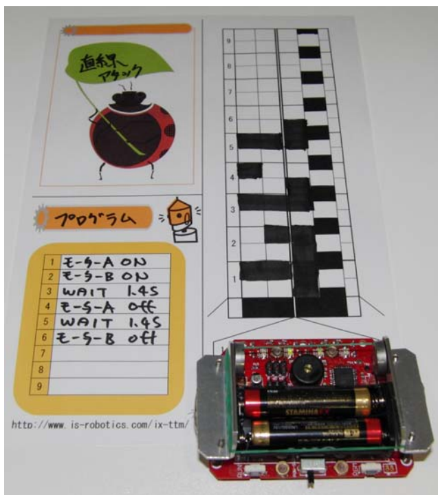
写真3：プログラムカードを使いプログラミングの様子 (外形カバー 2 を外しています)
